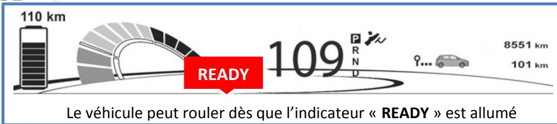
Engagez le levier **de vitesse** en position **D.**(pour avancer) ou **R.**(pour reculer). Le véhicule roule dès que vous **lâchez la pédale de frein** (sans appuyer sur la pédale d'accélérateur).
